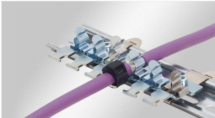
EMCローフットは、個々のケーブルシールドをアース電位に接続する場合に使用され、ケーブルを安全かつ簡単にシールドすることができます。様々な長さを用意しており、用途に応じて最大12個のSKLシールドクランプを自由に装着できます。
